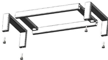
Рис. 1. Сборка высокого каркаса
